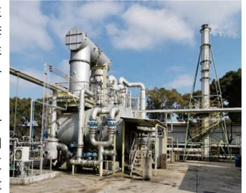
☑ 生產、公用、製程技術單位共同檢討天然氣及用電需求，從鹼洗塔溫度和 pH 值控制、生產排程調度、提高反應轉化率、廢氣稀釋和燃燒空氣風量等各方面著手，確認操作條件之最有效率控制點。改善後相較 2020 年已降低天然氣單耗 42%、降低用電單耗 11.8%。
