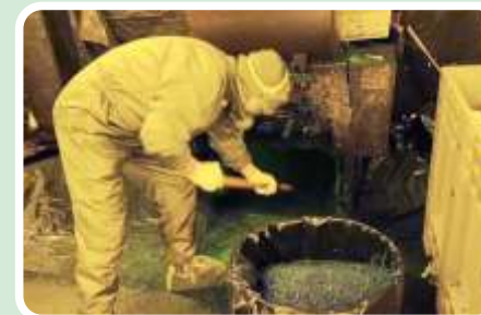
膠塊經破碎後，適度回摻製程做為原料
